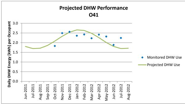
Figure A-167 Projected DHW Performance, O41
