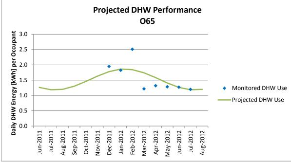
Figure A-196 Projected DHW Performance, O65
