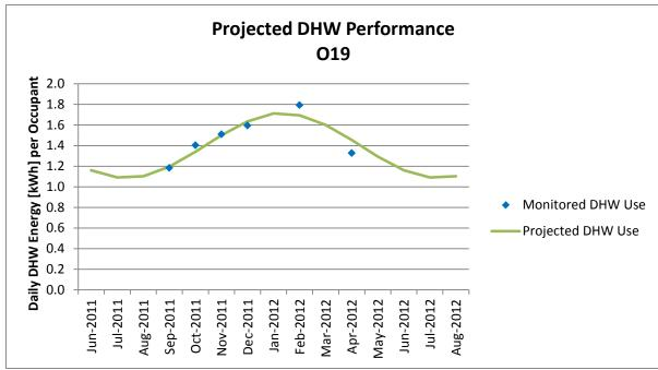
Figure A-125 Projected DHW Performance, O19
