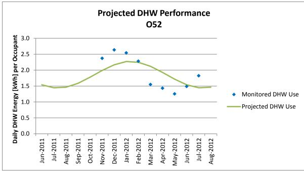
Figure A-175 Projected DHW Performance, O52
