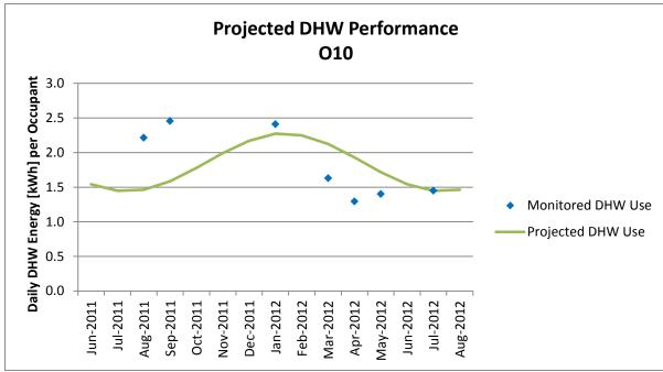
Figure A-111 Projected DHW Performance, O10
