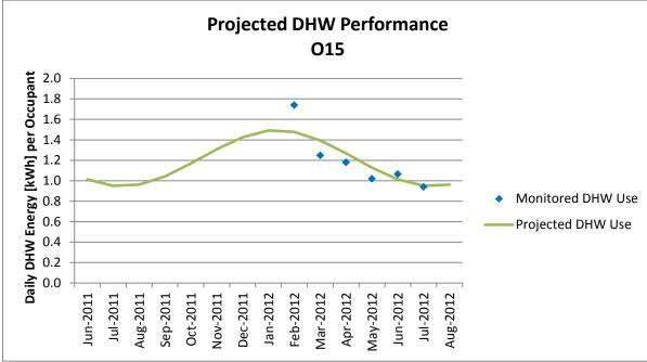
Figure A-120 Projected DHW Performance, O15
