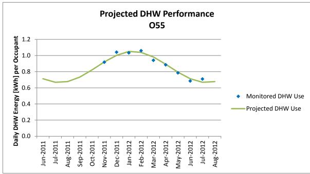
Figure A-183 Projected DHW Performance, O55
