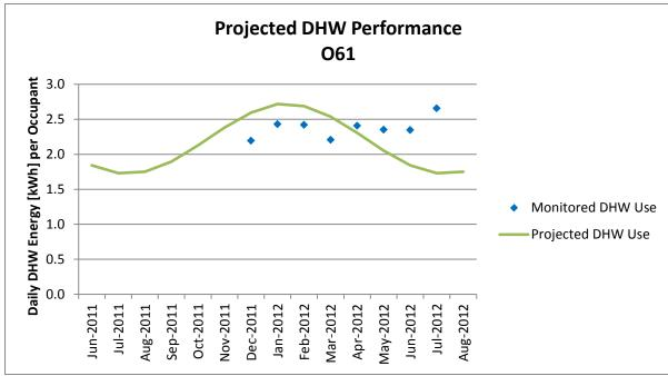
Figure A-193 Projected DHW Performance, O61
