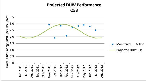
Figure A-178 Projected DHW Performance, O53
